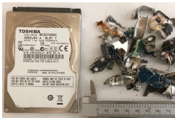
2.5" Enterprise HDD DIN 66399-H4 (9 mm wide blade)
