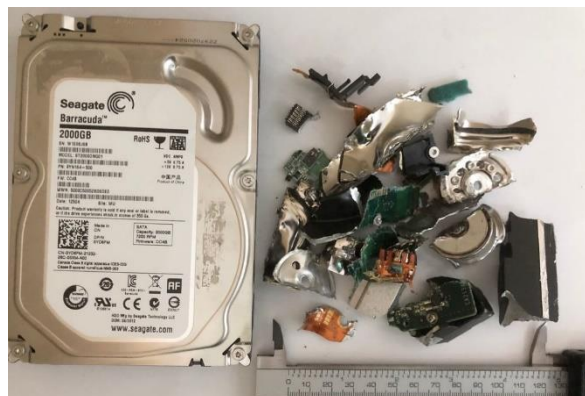
3.5" Enterprise HDD DIN 66399-H4 (18 mm wide blade)
